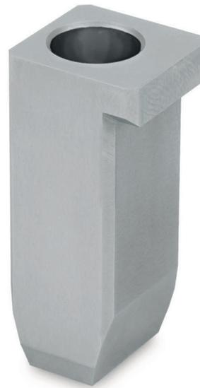
**Je nach Bedarf:** Der Streifenpositionierer E 5654, der entweder beidseitig gefedert für die Zentrierung oder einseitig starr um 90° gedreht für den Bezug auf der Außenkante verwendet werden kann, ist ab Lager in drei Größen verfügbar © Meusburger
